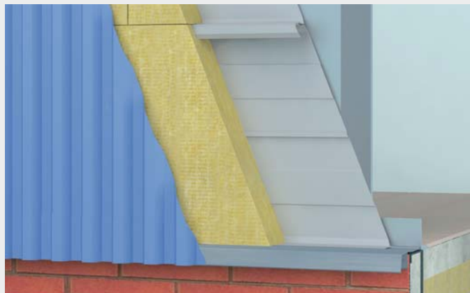
WIZ. 518.3. Przykręcanie blachy elewacyjnej.
